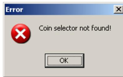
Il software ricerca il selettore soltanto all'accensione. Se il selettore viene collegato in seguito, è necessario premere il tasto **[Search]** per far fare la ricerca del selettore. Questa operazione va fatta quindi ad ogni cambio di gettoniera.
