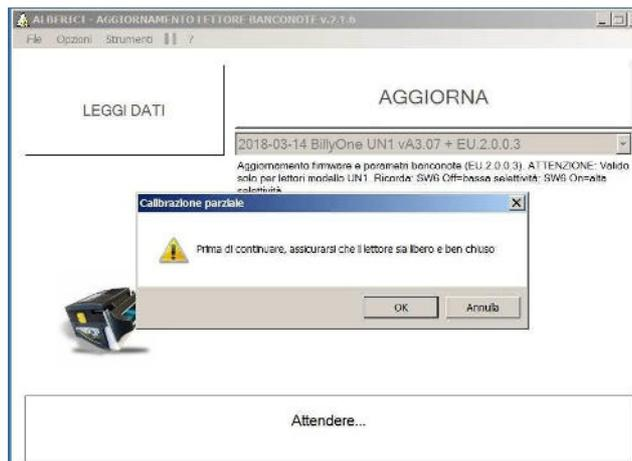
Assicurarsi che non ci siano impedimenti all'espulsione delle banconote processate dal lettore, e che la conchiglia superiore del lettore sia inserita fermamente in quella inferiore, e premere il tasto OK. Apparirà il seguente prompt:
