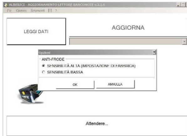
Scelta l'opzione, o immediatamente se non sono state abilitate le funzionalità avanzate nel menu Opzioni/ Opzioni avanzate, il programma avvisa di controllare che il lettore sia chiuso e vuoto.
