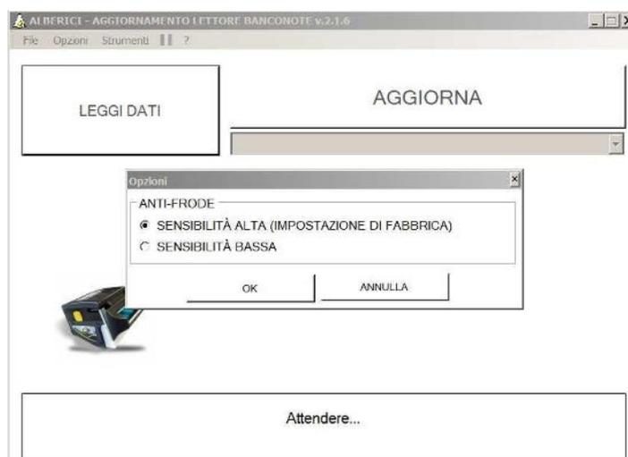
Una volta scelta l'opzione, o immediatamente se non sono state abilitate le funzionalità avanzate nel menu Opzioni / Opzioni avanzate, partirà la calibrazione. Se la Carta di calibrazione non è inserita, il programma invita a posizionarla e a rilanciare il processo:
