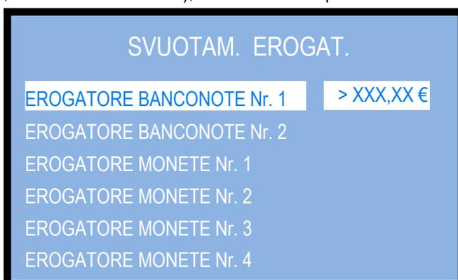
Se si resta nel menu di svuotamento per oltre 1 minuto senza fare nessuna operazione (es. ci si dimentica di uscirne dopo operazioni di servizio), il sistema torna in stand-by, per evitare il rischio che estranei abbiano accesso ai comandi.
