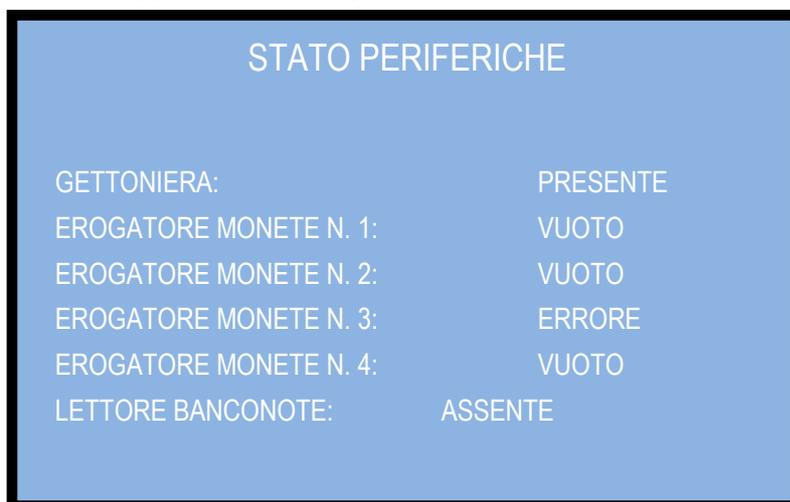
La schermata in esempio indica che: la gettoniera è collegata e funzionante, l'Hopper n. 1 e il n. 2 sono collegati e funzionanti, ma non risultano monete al loro interno, l'Hopper n. 3 è collegato ma non è funzionante, l'Hopper n. 4 è scollegato, e il lettore banconote è presente ma si è verificato un errore di funzionamento.
