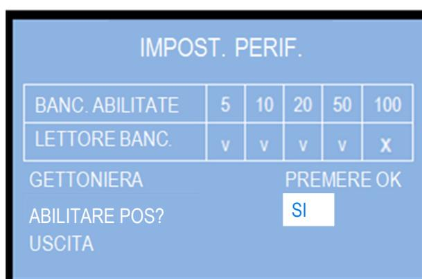
Premere OK per tornare alla funzione ABILITARE POS?, quindi premere "+" per passare a USCITA, quindi nuovamente OK per tornare al livello di menu superiore.
