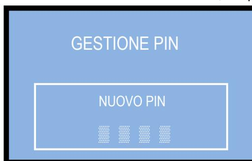
Man mano che ogni singola cifra del nuovo PIN viene confermata, viene sostituita da un asterisco, impedendo così ad estranei la visualizzazione del codice. Una volta confermato l'intero nuovo PIN, la macchina esce automaticamente dalla funzione e torna alla schermata del menu di configurazione.
